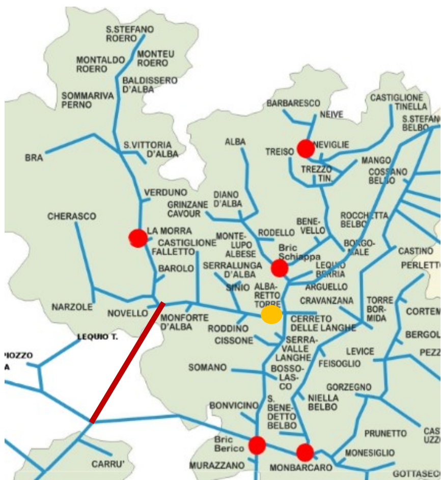
Figura 3 - Estratto schema rete distributiva Acquedotto Langhe e Alpi Cuneesi
